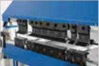
Alle drei Werkzeuge segmentiert und mit Schnellwechselsystem
