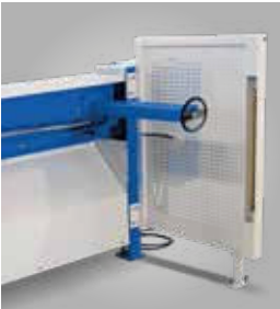
Rückraum durch Lichtschranke abgesichert
