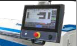
Bedienerfreundliche 15,6" Touchscreen NC-Steuerung an ergonomischen Schwenkarm
